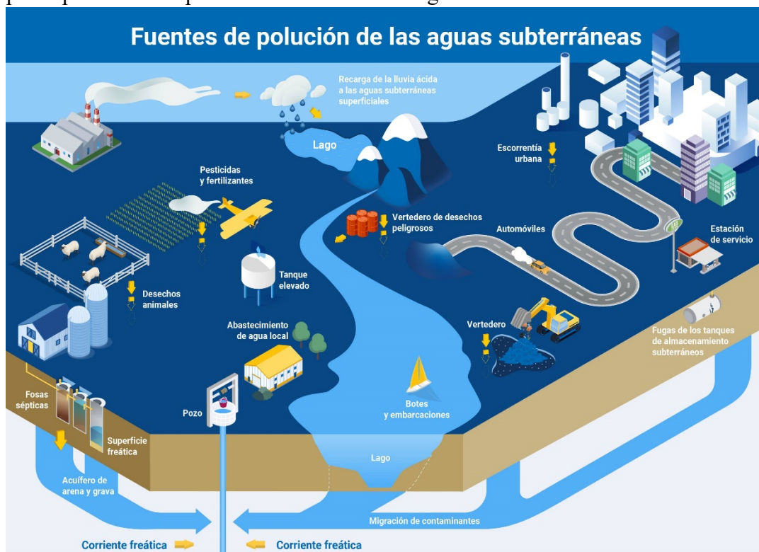
Fuentes probables de contaminación de las aguas subterráneas debido a actividades humanas. (Infografía: A. Vargas/OIEA)
